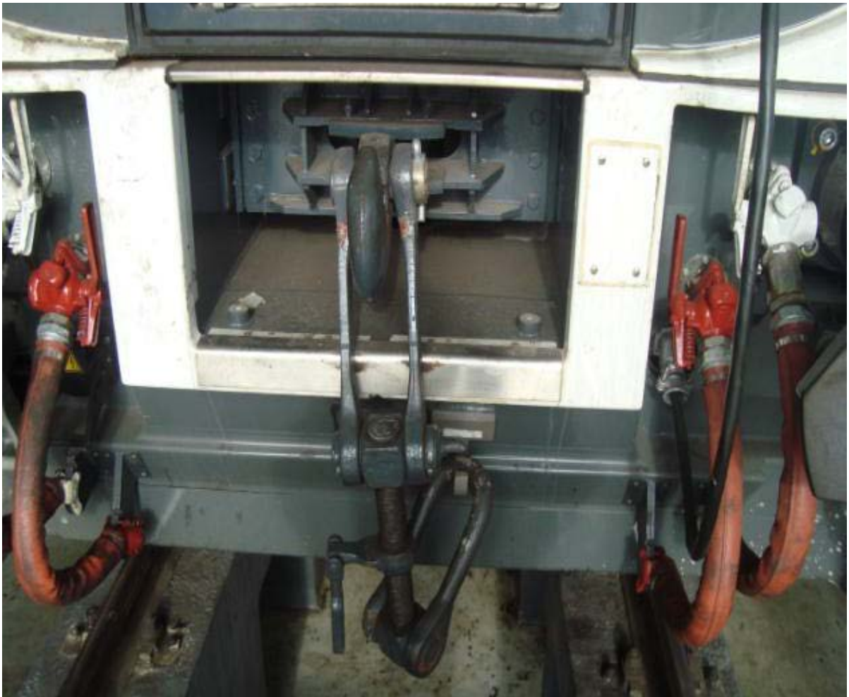
Слика 1. Крајња страна Talgo гарнитуре са одбојничким и уређајима за квачење
